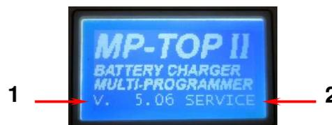
**ACHTUNG!** Das Ladegerät nicht regulär einschalten sollte oder nicht regulär funktionieren sollte, ist es möglich ein **Reset** des Gerät zu machen. Sie müssen die **ENTER-Taste** für 10 Sekunde drücken.
