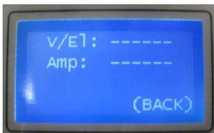
Durch den Anschluss des MP-TopII an das zuständige Ladegerät wechselt das Display zur Anzeige von Spannung und Ladestrom:
